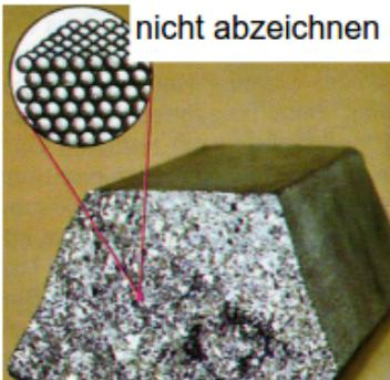
In Metallen sind die Atome regelmäßig angeordnet. Man spricht daher auch von einem **Metallgitter**. Da die Metallatome eines Elementes gleich groß sind, können sie sich ganz dicht zusammenlagern.
