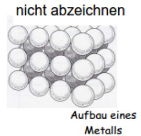
Wenn Du Dir die Metalle im PSE ansiehst, erkennst Du, dass Metalle nur wenige Außenelektronen besitzen. Die Metallatome streben danach, ein Oktett zu erlangen. Die einfachste Möglichkeit zu einem Oktett zu gelangen, ist es, die Außenelektronen abzugeben. Es entstehen **positiv geladene Atomrümpfe** (= positiv geladene Metallionen).
